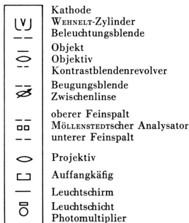
Abb. 1. Experimentelle Anordnung zur Messung des Kontrasts mit ungefilterten und gefilterten Elektronen.
